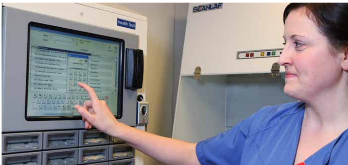
Digital registrering: Sykepleier Unn Mari Olsen ved Øya helsehus logger seg inn og registrerer hvilken pasient hun skal hente ut medikamenter til. A-preparater kommer da ut kun i det antall pasienten skal ha. Foto: Unni Skoglund
